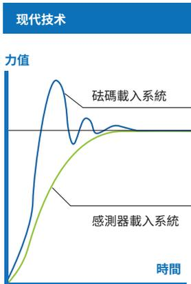
力感測器，閉環，力反饋系統
